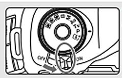
Coloque o interruptor de alimentação na posição <ON>
